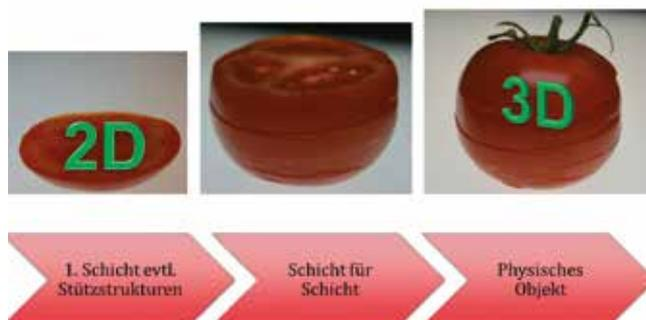
**Abb. 2:** Entstehung eines physischen Modells mittels Schicht-für-Schicht-Aufbau.
