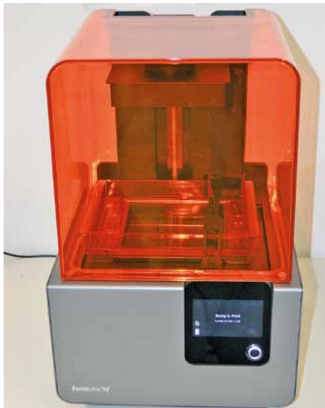
**Abb. 13:** SLA-Gerät der Firma Formlabs.
