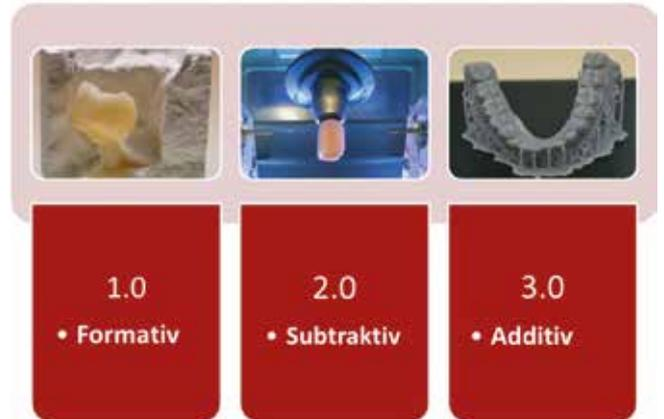
**Abb. 3:** Einteilung der in der Zahnmedizin verwendeten Fertigungsverfahren.
