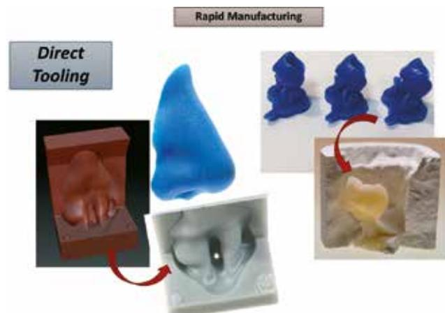
**Abb. 7:** Rapid Manufacturing von Hilfswerkstücken für die Fertigung von z. B. Epithesen oder Modellgussprothesen (etwa ein Wax-up für die Presskeramik).
